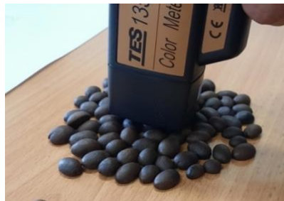
Gambar 24 Proses Pengambilan Data Warna pada Biji Kopi Hasil Roasting
