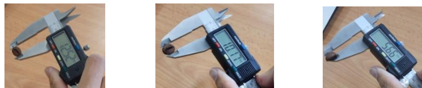
Gambar 20 Pengukuran Dimensi Biji Kopi
