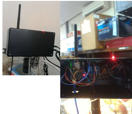
Gambar 4.1 Tampak luar dan dalam node
