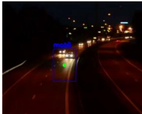
Gambar 4.15 Kesalahan sistem pendeteksi pada kondisi pencahayaan minimal
