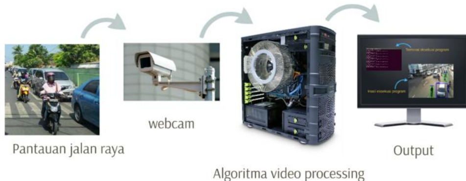
Gambar 3.1 Perancangan sistem klasifikasi dan penghitung kendaraan
