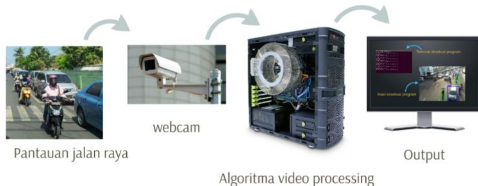
Gambar 3.1 Perancangan sistem klasifikasi dan penghitung kendaraan
