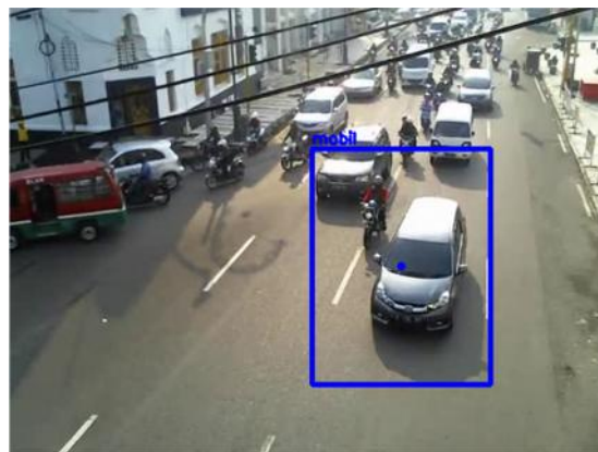
Gambar 4.12 Kesalahan sistem mendeteksi objek yang saling berdekatan
