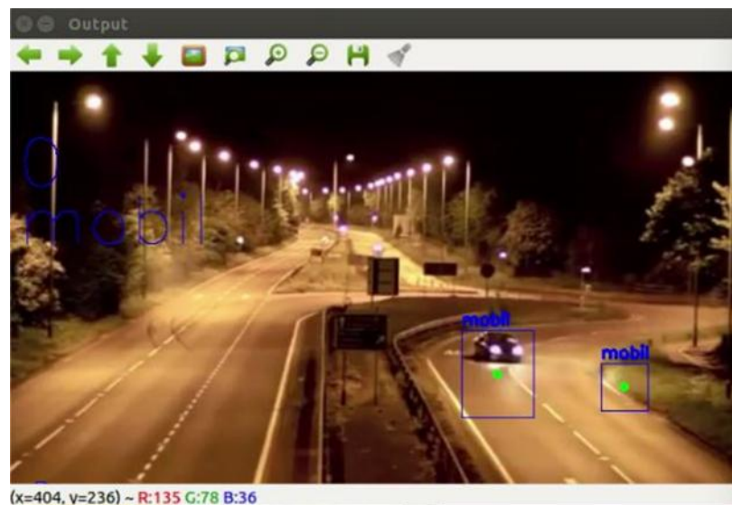
Gambar 4.18 Posisi kamera di depan objek mendeteksi ruang tembak cahaya lampu sebagai foreground
