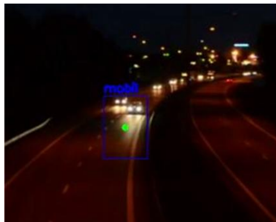
Gambar 4.15 Kesalahan sistem pendeteksi pada kondisi pencahayaan minimal
