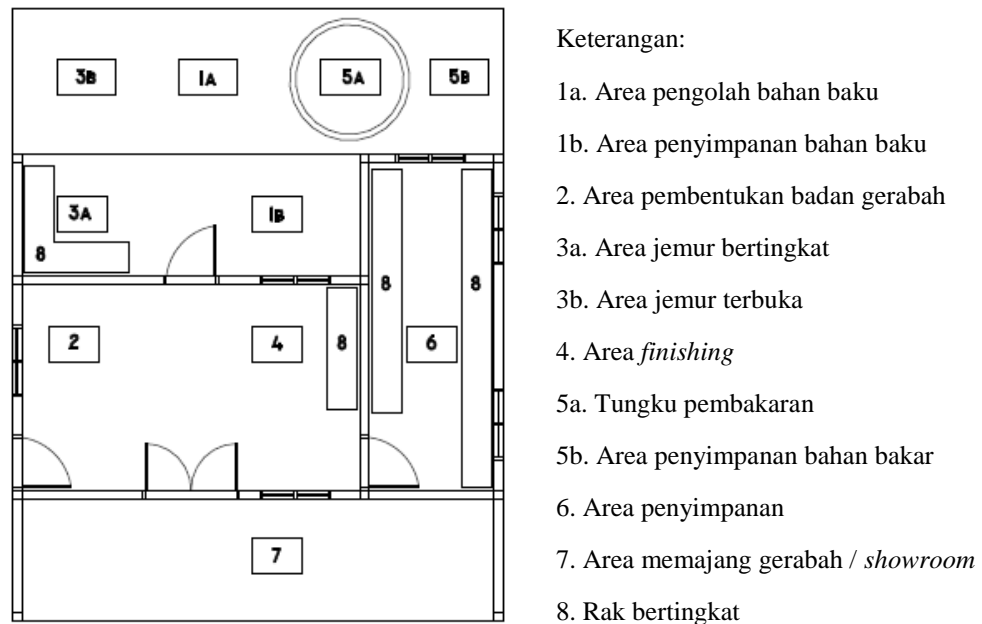
Gambar 13. Sistem seting pembuatan gerabah (Sumber: Pakarti, 2012; Purnamasari, 2012; Wardhani, 2012)
