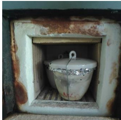
Gambar 4.5 Proses Aktivasi Arang Tunggak Bambu Petung
