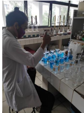
Gambar 4.12 Proses Pengujian Daya Serap Arang Aktif Tunggak Bambu Petung terhadap Biru Metilen
