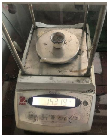
Gambar 4.8 Proses Penimbangan Kadar Zat Mudah Menguap Arang Aktif Tunggak Bambu Petung
