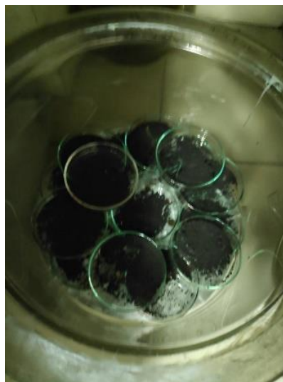
Gambar 4.11 Pengujian Daya Serap Arang Aktif Tunggak Bambu Petung terhadap Benzena
