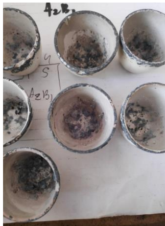
Gambar 4.9 Pengujian Kadar Abu Arang Aktif Tunggak Bambu Petung
