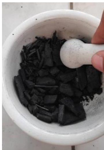
Gambar 4.4 Proses Penumbukan Arang Aktif Tunggak Bambu Petung
