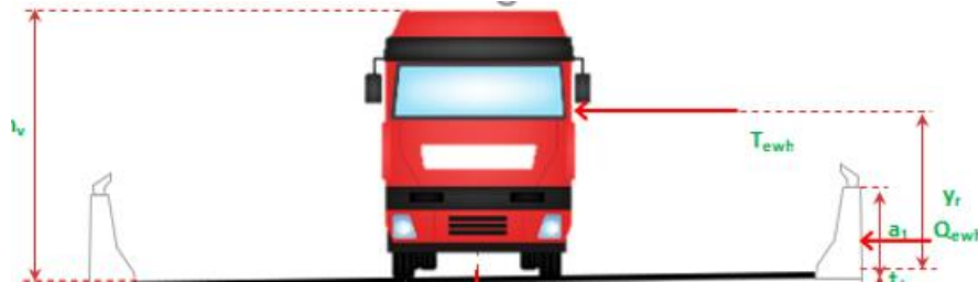
Gambar 5.4 Ilustrasi beban angin pada kendaraan
