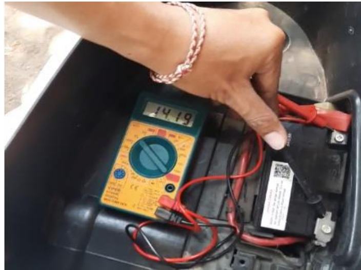
Gambar 4.2 Output tegangan putaran tinggi
