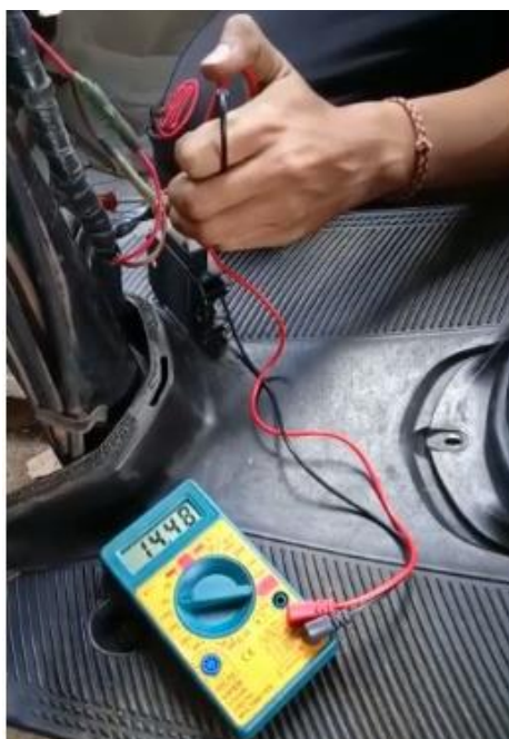
Gambar 4.6 Pengukuran output tegangan putaran tinggi
