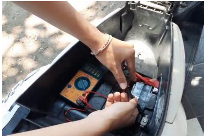
Gambar 4.1 Output tegangan putaran stasioner
