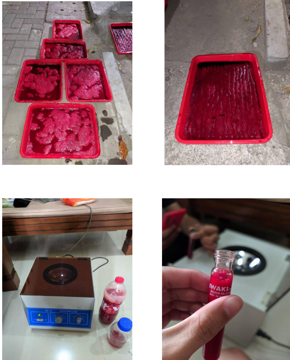
Gambar 3. 10 Pembuatan pelumas bovine blood serume
