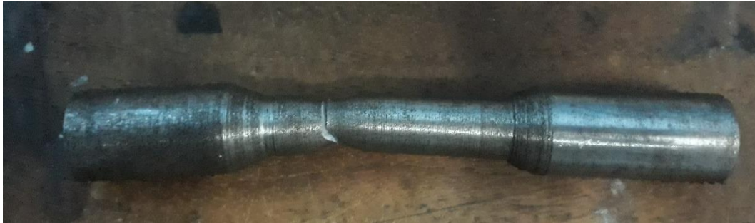
Gambar 4.24 Spesimen hasil uji tarik spesimen tipe A
