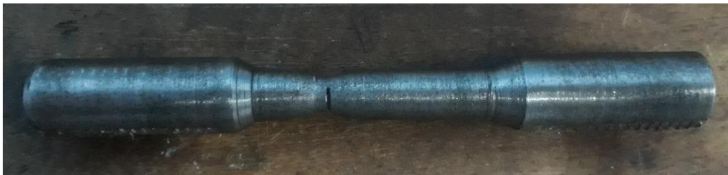
Gambar 4.25 Spesimen hasil uji tarik spesimen tipe B
