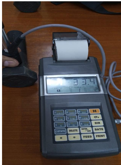
Gambar B.2 Hasil spesimen pengujian kekerasan spesimen tipe B
