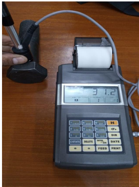
Gambar B.1 Hasil spesimen pengujian kekerasan spesimen tipe A
