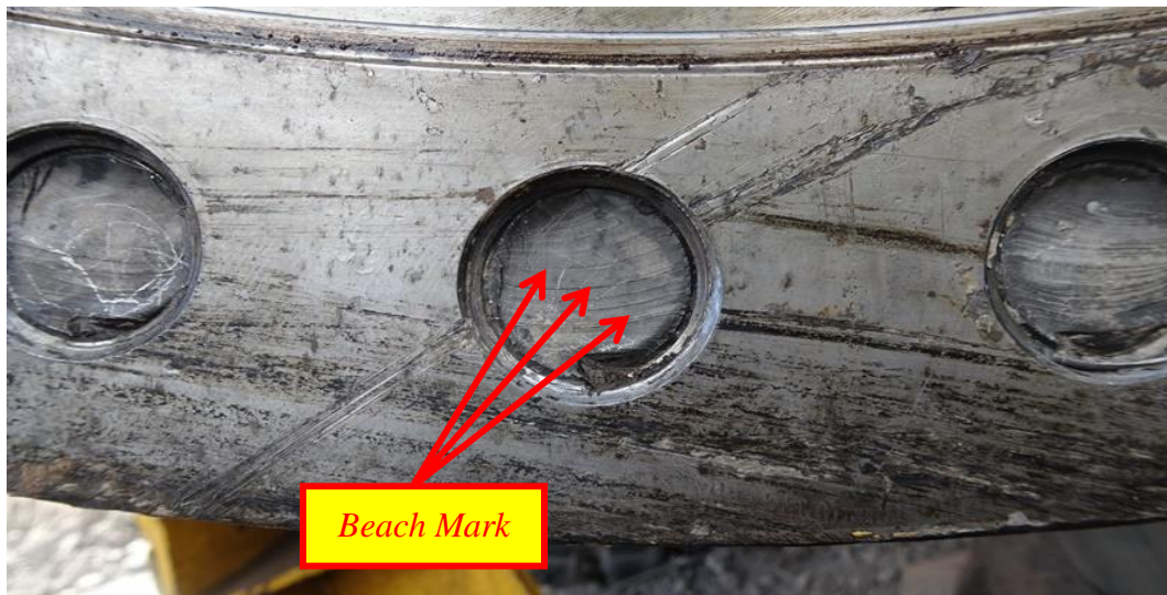
Gambar 4.16 Patahan baut final drive pada lubang baut
