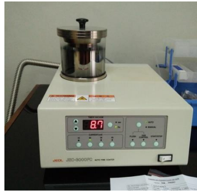
Alat Sputter chamber preparasi SEM
