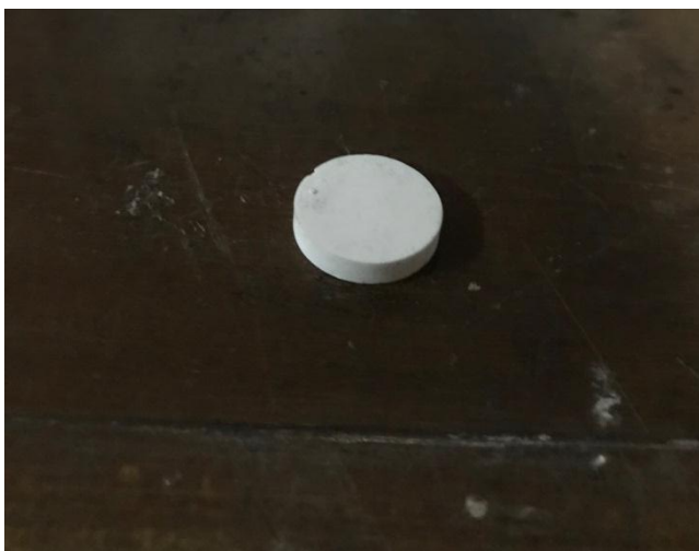
Lampiran 25. Spesimen uji konduktivitas termal hasil sintering
