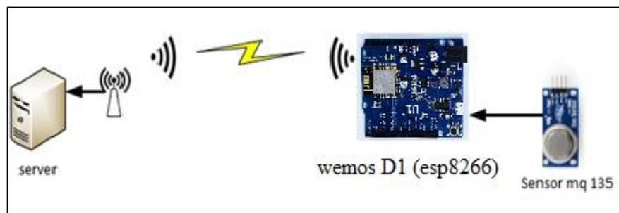
Gambar 3. 8 Perancangan Topologi Jaringan ESP8266
