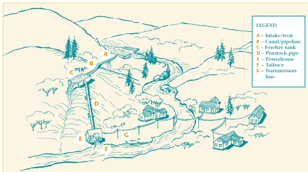
Gambar 2.6. Komponen Utama Pada Pembangkit Listrik Run-Off-River. (CETC, 2004)
