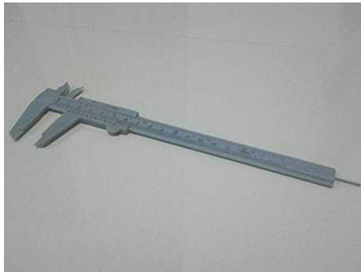
Gambar 4.5. Kaliper atau Jangka Sorong
