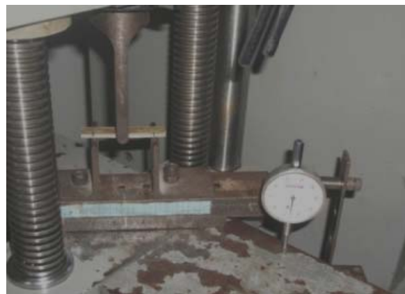
Gambar 4.14. Pengujian Bending komposit serat-epoxy
