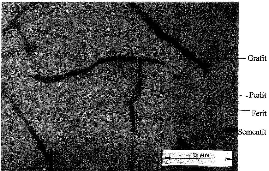
Gambar 4.4 Struktur mikro pulley PT Yanmar sesudah dietsa
