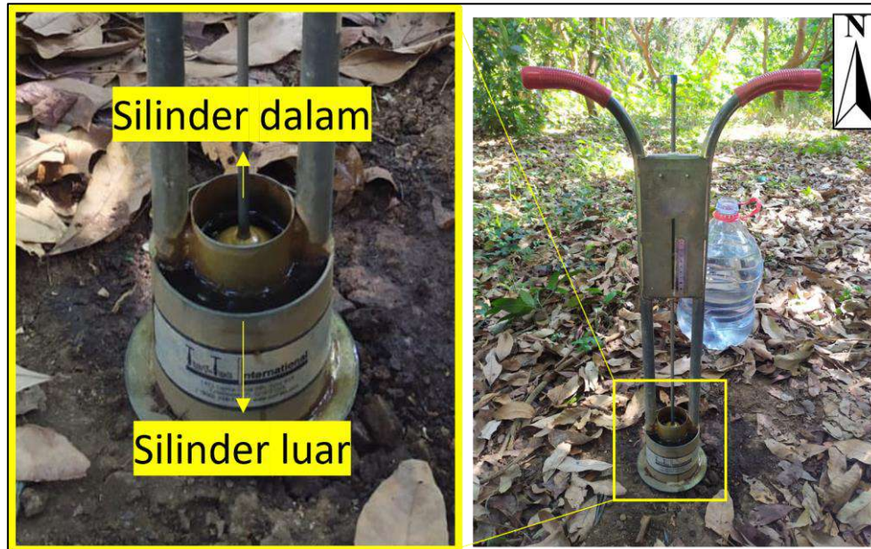
Gambar 4.14. Pengukuran laju infiltrasi di lapangan menggunakan infiltrometer.
