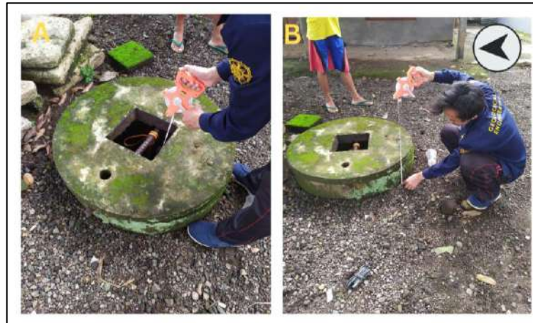
Gambar 4.17. Pengukuran sumur gali warga menggunakan meteran di daerah penelitian; a) mengukur kedalaman muka air tanah sumur gali, b) mengukur tinggi dinding sumur.
