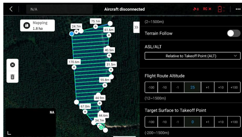
Gambar 4.1. Jalur terbang area pemotretan menggunakan DJI Pilot 2 (Data Lapangan, 2023)
