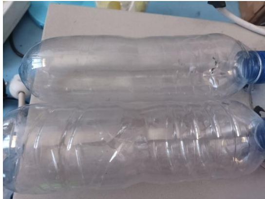
Gambar 5.4. Perbedaan botol yang dihaluskan menggunakan elemen pemanas (atas) dengan tidak di haluskan (bawah)
