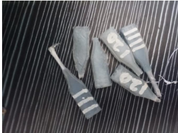
Gambar 4.11. Speciment yang putus setelah uji tarik
