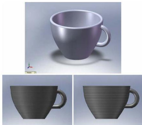
Gambar 3.11. Penerapan additive manufacturing pada 3D print cangkir [19].
