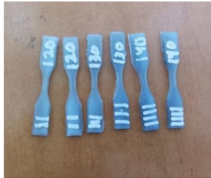
Gambar 4.9. Spesiment standard ASTM 638 D tipe V
