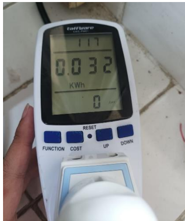
Gambar 4.13. Pengukuran daya yang digunakan mesin pultrusion
