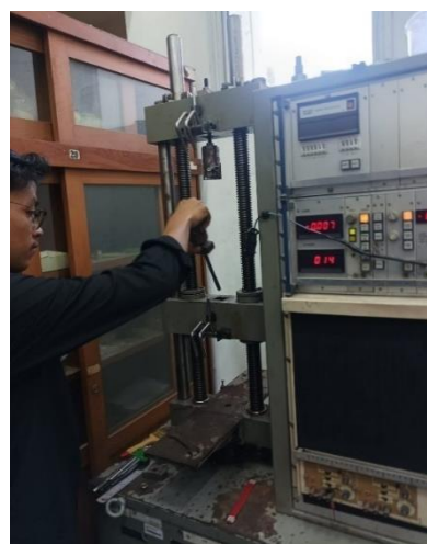
Gambar 4.10. Memasukkan speciment ke mesin uji tarik
