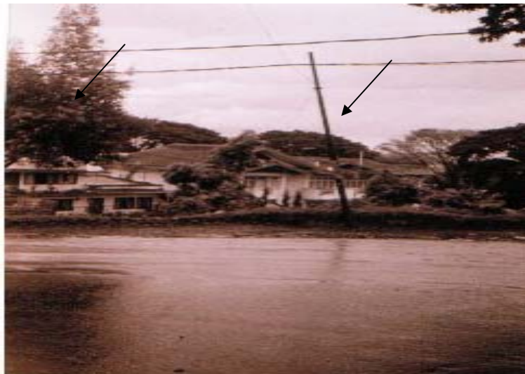
Gambar 4.19. Fenomena Rayapan Tanah Ditunjukkan Oleh Gejala Miringnya Tiang Listrik dan pohon Ditemukan pada Satuan Medan Lereng Tengah Gunungapi Berlereng curam Penggunaan Lahan Prasarana Fisik Jenis Tanah Regosol (V.V.Pf.Reg) di Kecamatan Guguk Panjang.
