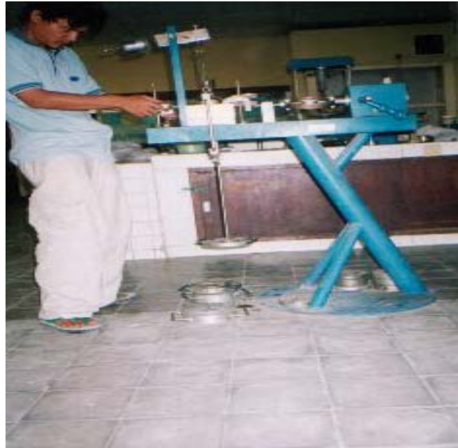
Gambar 4.21. Pemasangan Sampel Tanah Pada Alat Direct Shear
