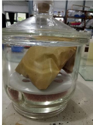
Gambar 3.5 Proses Pendinginan Seresah dengan Desikator
