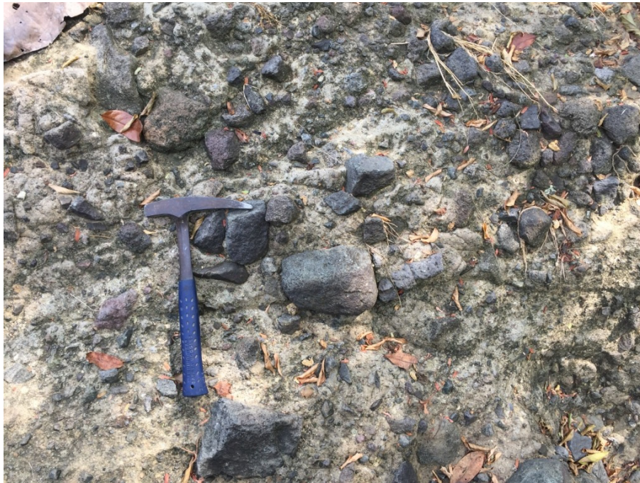
Gambar 5.6. Kenampakan breksi andesit dalam satuan breksi andesit di STA 4
