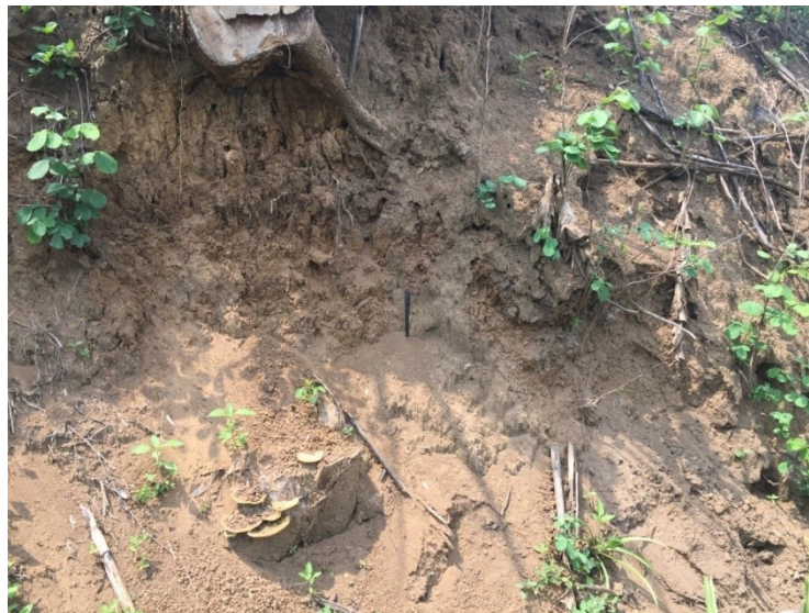
Gambar 5.9. Kenampakan tanah dalam satuan lanau pasiran di STA 57
