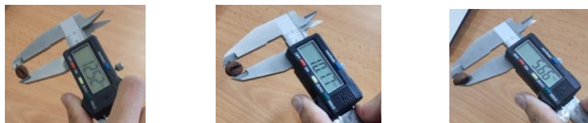
Gambar 20 Pengukuran Dimensi Biji Kopi
