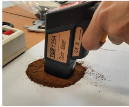
Gambar 25 Proses Pengambilan Data Warna Bubuk Kopi Hasil Penyangraian
