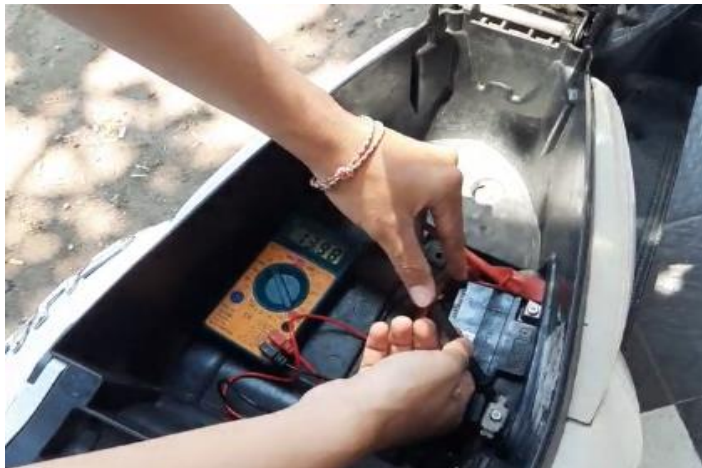
Gambar 4.1 Output tegangan putaran stasioner
