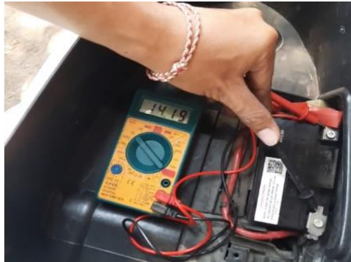
Gambar 4.2 Output tegangan putaran tinggi
