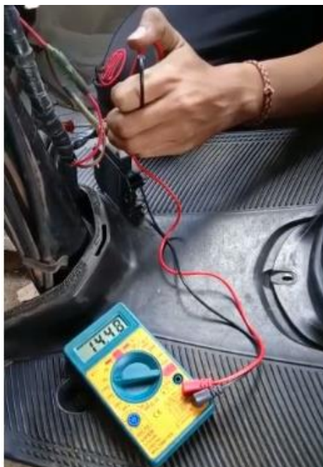
Gambar 4.6 Pengukuran output tegangan putaran tinggi
